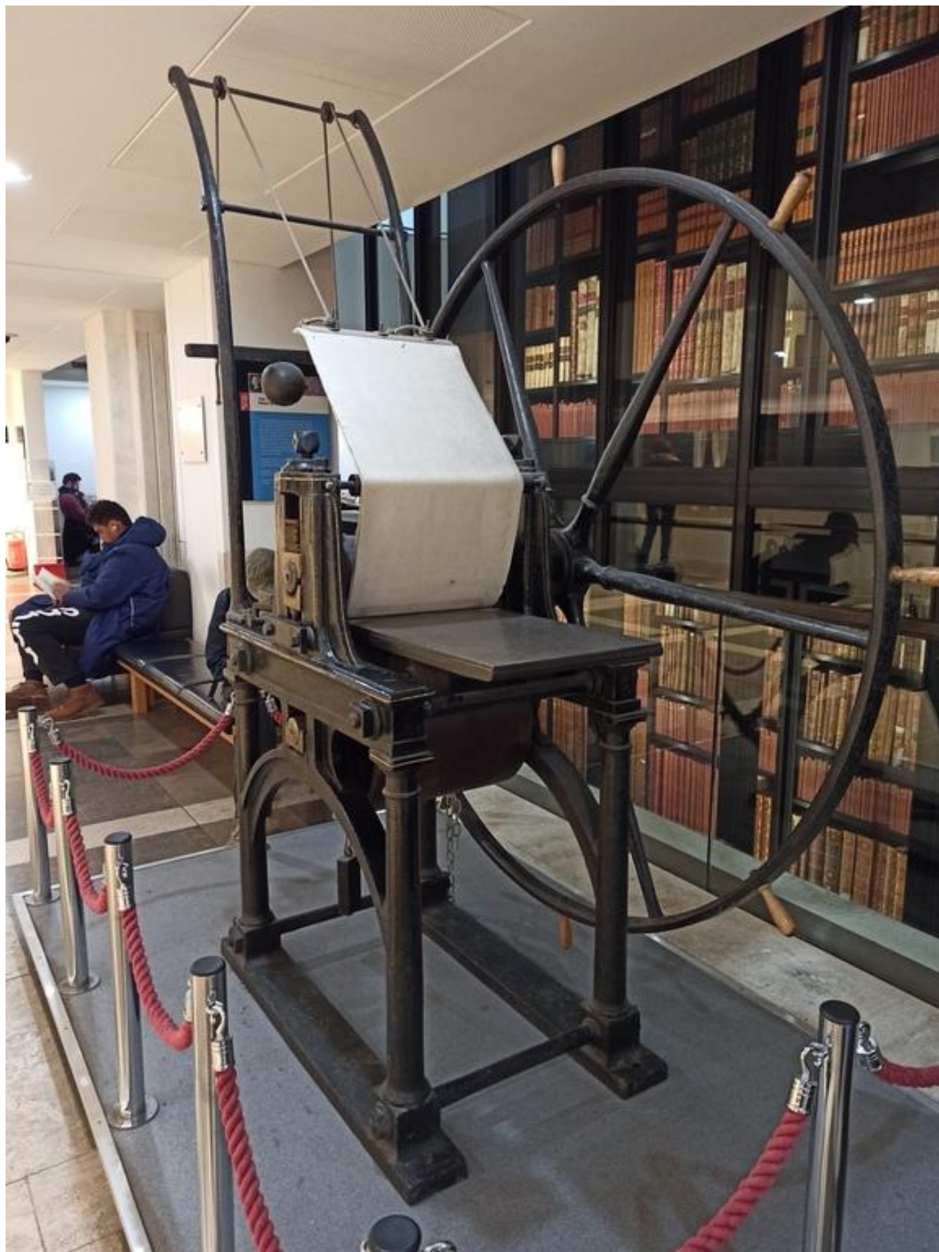
[23] Perkinsův cylindrický tiskařský lis připomíná zásluhy amerického vynálezce Jacoba Perkinse [24]
